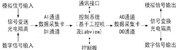
图1 控制系统的硬件结构
