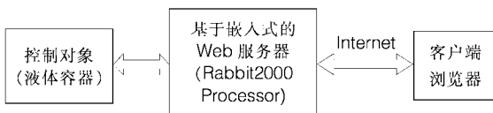
图 1 液位控制系统的体系结构
