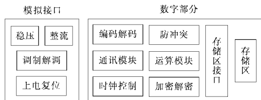
图 1 非接触式 IC 卡内部结构框图
