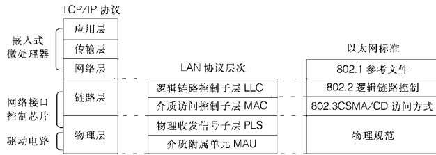
图 1 网络协议分层示意图
