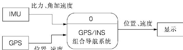
图 4 GPS/INS 组合导航系统的数据流图 (DFD/L0)
